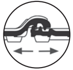
Rys. 65. | Przekrój poprzeczny przez rozciągnięte na zamkach dachówki
