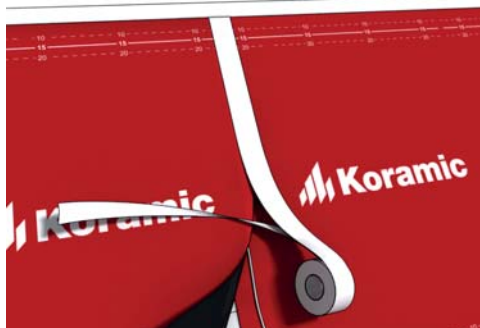
Rys. 83. | Pionowe łączenie membrany
